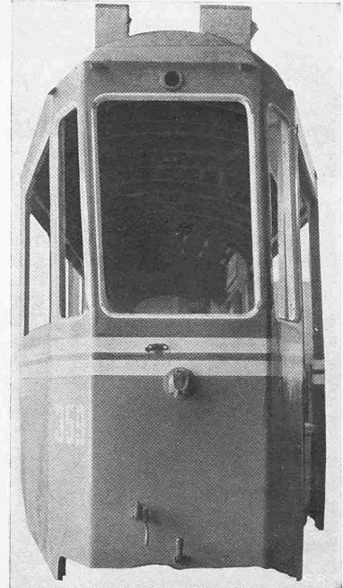
Abb. 6. Seitenwand rechts mit Eindrücken unten und oben vorn
