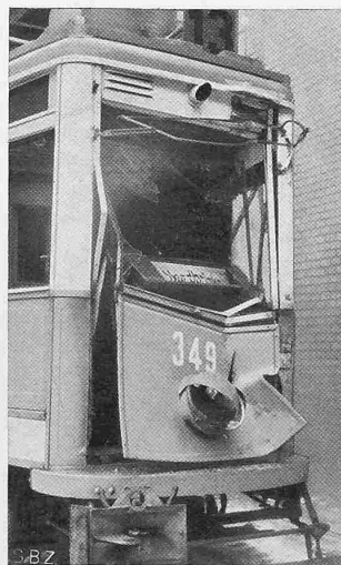
Abb. 2. Holzgerippe-Wagen nach Zusammenstoss unter ähnlichen Verhältnissen
