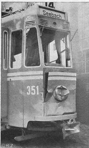
Abb. 1. Stahlschalenbauart nach Zusammenstoss unter ähnlichen Verhältnissen
