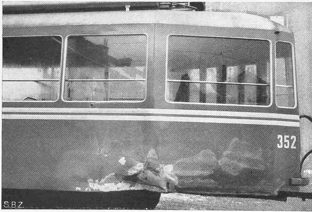
Abb. 3. Metallwagen nach seitlichem Zusammenstoss
