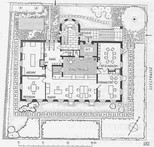
Abb. 3. Lageplan mit Erdgeschoss-Grundriss, 1 : 400
