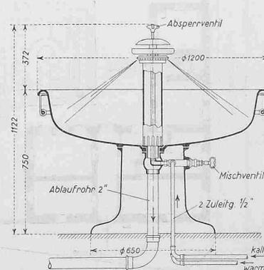
Abb. 3. v. Roll Klus: Emaillierte Guss-schale mit Bradley-Armatur
