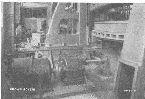
Modernisierter Antrieb einer Karussell-Drehbank durch stufenlos regulierbaren Nebenschluß-Kommutatormotor
