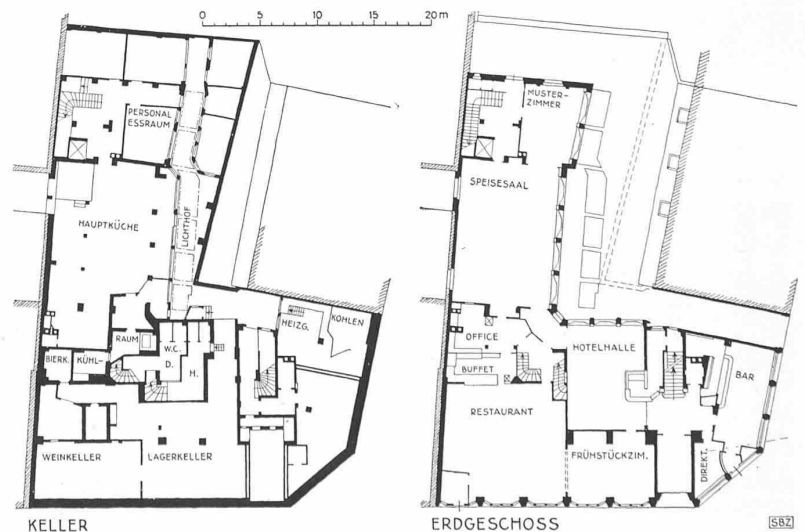
Abb. 16 und 17. Grundrisse des ehemaligen Cityhotels im Masstab 1 : 600 zum Vergleich mit Abb. 18 und 25
