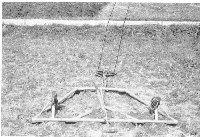
Abb. 9. Verankerung der Umlenkrolle an einem Strassenbord
