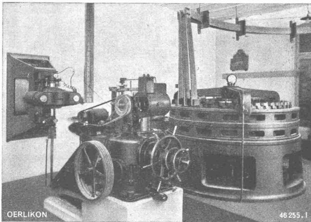
Vertikaler Oerlikon-Drehstromgenerator 210 kW, 100 V, 50 Hz, 187 U./min.
