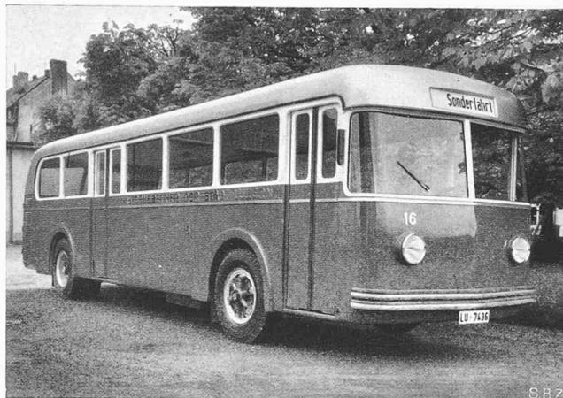
Abb. 5. Dieselelektrischer Heckmotor-Autobus der Stadt Luzern
