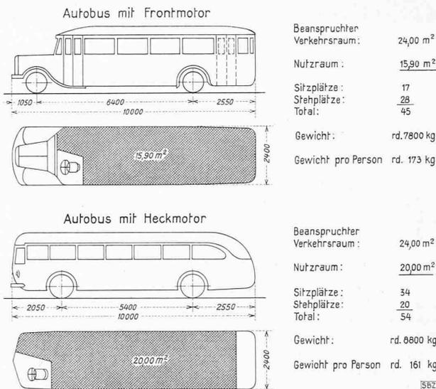
Abb. 1 und 2. Vergleich zwischen alter und neuer Bauart
