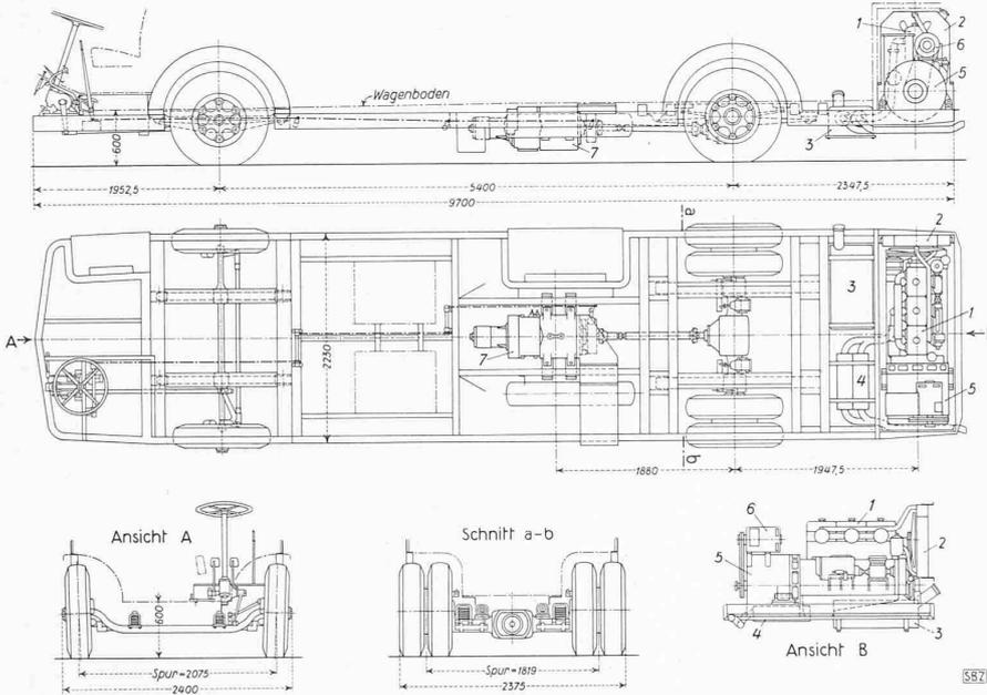
Abb. 3. Dieselelektrischer Autobus mit Heckmotor der Strassenbahn Luzern, Fahrgestell 1 : 80
