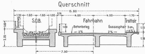
Abb. 5. Schnitt der Kanalbrücken. — 1 : 250
