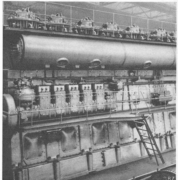
Abb. 2. 9000 PS<sub>e</sub> Sulzer-Zweitakt-Dieselmotor für das E. W. der Stadt Bukarest, auf dem Prüfstand in Winterthur. In halber Maschinenhöhe der Regler, rechts Brennstoffpumpen
