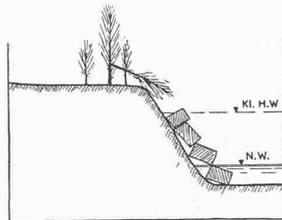
Abb. 5. Rationeller Uferschutz durch Betonblöcke und umgelegte Weiden
