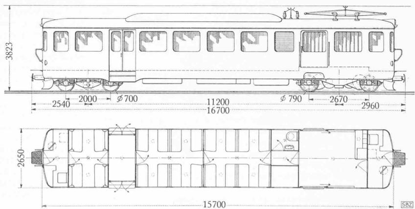
Abb. 15. Zahnrad-Triebwagen der Furka-Oberalpbahn (Meterspur) 1 : 150
