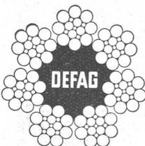
drallarme und spannungsfreie Normal-Litzen-Konstruktion
