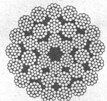
torsionsfreie Litzen-spiral-konstruktion mit Faserstoffeinlagen
