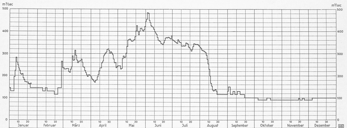
Abb. 3. Abflussmengen entsprechend dem Zonenreglement (Abb. 2) und der dort eingezeichneten Seesandkurve
