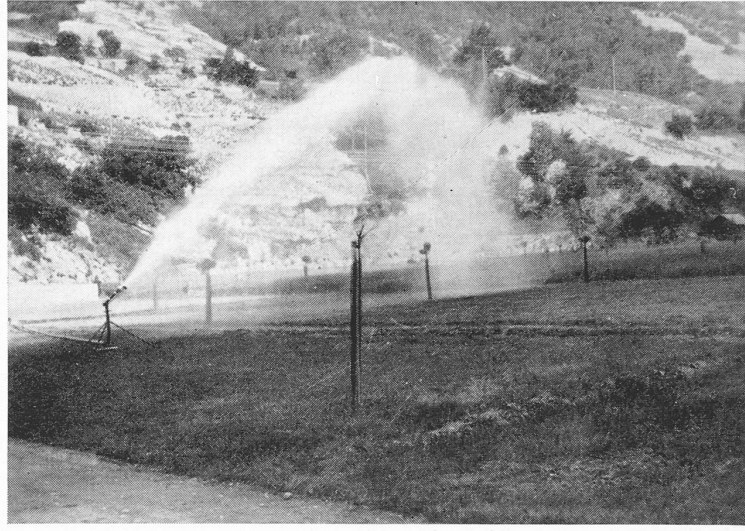
Abb. 7. Beregnungsanlage mit Strahlrohr auf dem Gutsbetrieb Hohbrunn der Landwirtschaftlichen Schule Oberwallis. — Wurfweite bis 50 m
