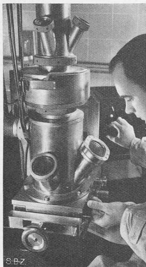
Abb. 4 (links). Elektronen-Uebermikroskop von Siemens
