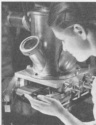
Abb. 5 (unten). Einschleusen einer photographischen Platte
