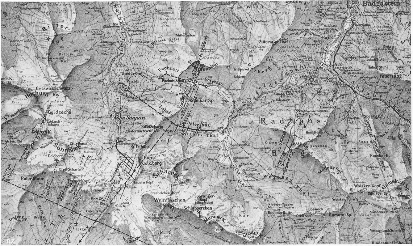
Abb. 5. Uebersichtskarte des Goldbergbau-Gebietes in den Hohen Tauern, mit Aufschliessungsprojekt von Oberberggrat Dr. Ing. K. Imhof. — 1 : 100000 Starke Linien: voll ausgeführte, gestrichelt projektierte Hauptförder- und Verbindungstrecken; feine Linien: alte Stollen mit Mundlöchern; Doppelstrich: gestrichelt Förderwasserstollen; desgl. voll Bremsberg neben Druckleitung des Kraftwerks Böckstein; strichpunkt. proj. Seilbahnen
