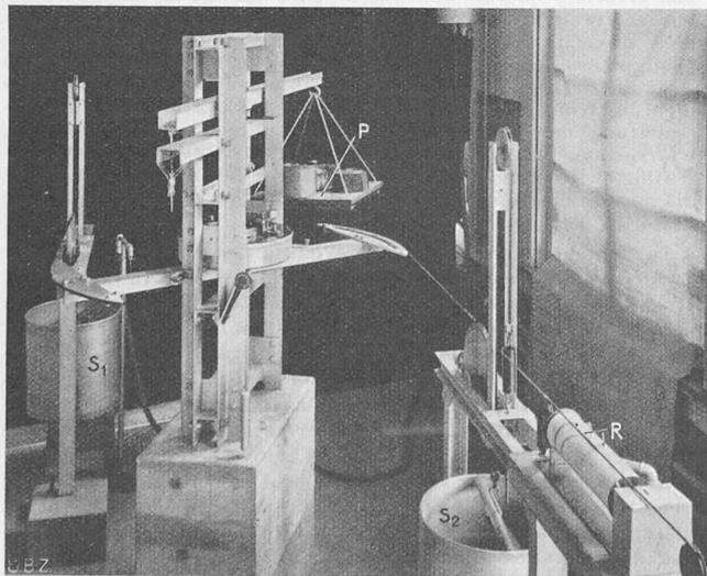
Abb. 13. Torsions- oder Kreisringscherapparat. P Belastungsplatte für Normalspannung. S<sub>1</sub>, S<sub>2</sub> Belastungskessel für Scherspannung. R Registriertrommel für Querverschiebungen
