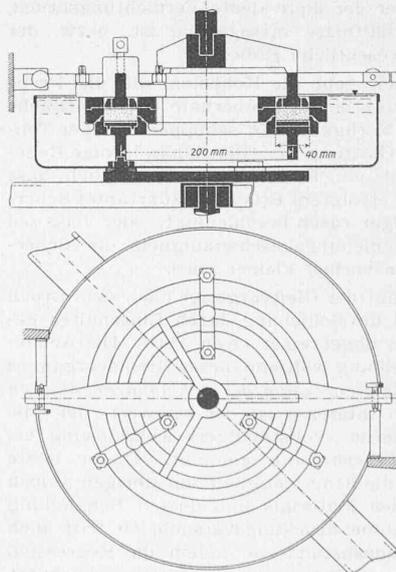
Abb. 14. Kreisringscherapparat, 1:8
