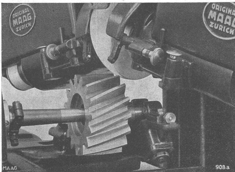
MAAG-ZAHNRADSCHLEIFMASCHINE für Stirn- und Schraubenverzahnungen
