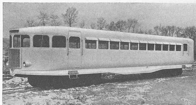
Abb. 4. Meterspur-«Micheline» mit Benzinmotor; 46 Sitzplätze
