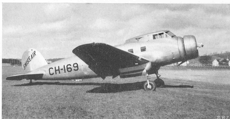
Abb. 6. Zehnplätziger Clark GA 43, ebenfalls einmotorig, Reisegeschw. 260 km/h 1934
