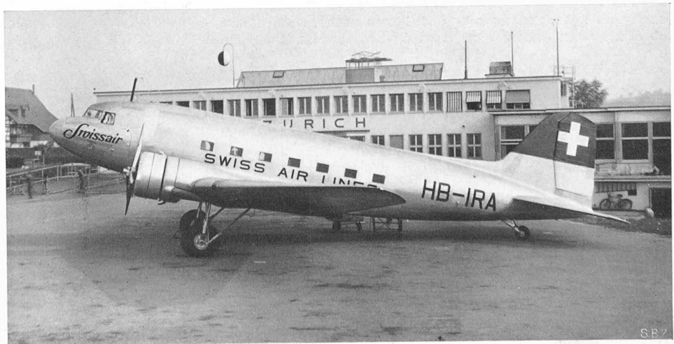
Abb. 9. 21-plätziger Douglas DC3 der «Swissair». 2 × 1000 PS, Reisegeschwindigkeit bis 290 km/h
