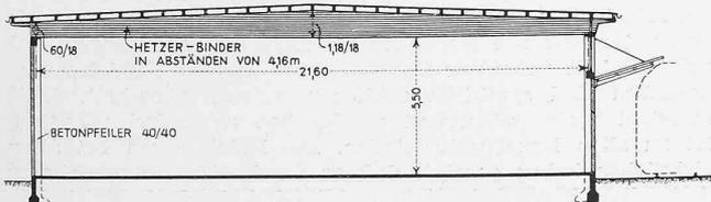
Abb. 1. Querschnitt 1 : 300 des Wollmagazins.
