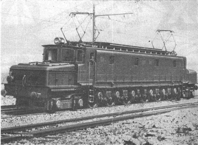
Norte-Bahn, Spanien. Schnellzuglokomotive 2 C<sub>0</sub> - C<sub>0</sub> 2,
