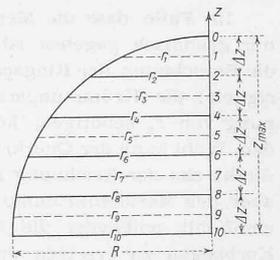
Die Längen  $r$  greifen wir in der Zeichnung ab ( $r : R = 0,435, 0,600, 0,715, 0,800, 0,865, 0,915, 0,955, 0,980, 0,995, 1$ ) und führen die Rechnung in Tabellenform nach obenstehendem Schema durch.
