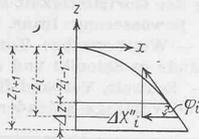
$\Delta X'' =$  Komponente der Resultierenden der im Längenelement des  $y$ -Meridianschnittes (zwischen den Schnittstellen zweier benachbarter Parallelkreise mit demselben) wirkenden Schubkräfte in Richtung der  $x$ -Axe;
