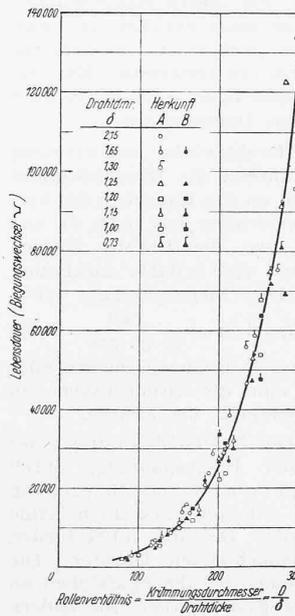
Abb. 1. Lebensdauer von Seil-drähten verschiedener Dicke und Herkunft.  $K_z = 130$  kg/mm<sup>2</sup>,  $\sigma_z = 30$  kg/mm<sup>2</sup>. Die Punkte sind Mittelwerte] aus je 10 Versuchen. (Prof. Woernle, T. H. Stuttgart.)
