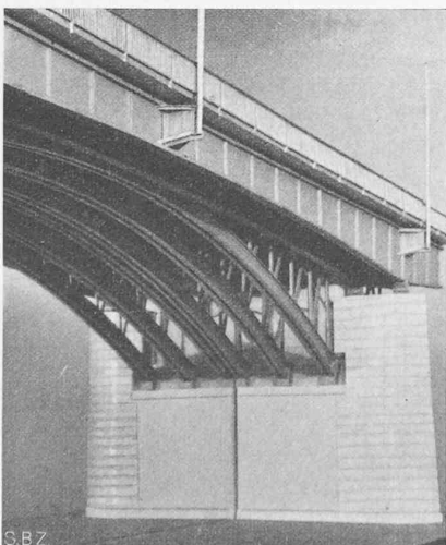
Abb. 3. Pfeilerpartie des amtlichen Balkenprojekts.
