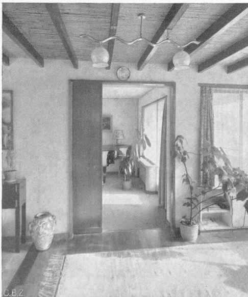
Abb. 11 u. 12. In Halle und Wohnraum: Freie Aussicht Sommer und Winter durch eiserne Schiebefenster (wie die Terrassen-Sonnenstoren nach System Illi).
