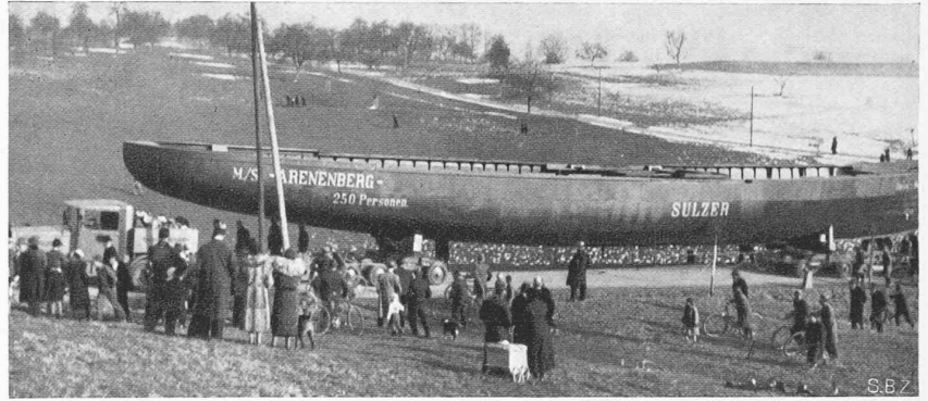
Schiffschale-Strassentransport Winterthur-Konstanz auf Rollschemeln. — Links Traktor; darüber das Heck der 34 m langen und 5,6 m breiten Schale von 24 t Gewicht.
