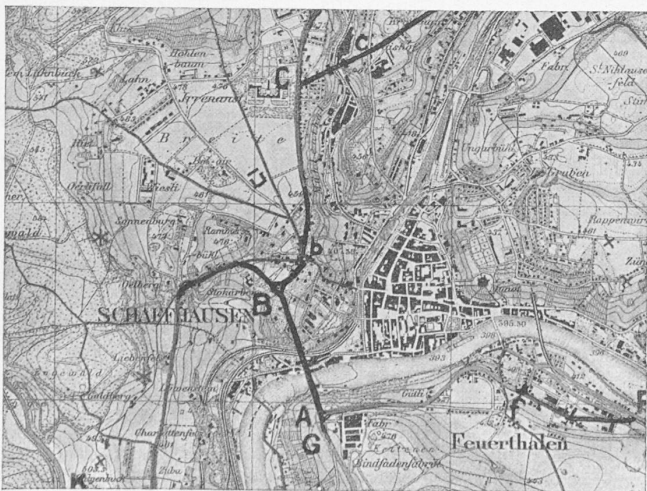
Unprämierter Entwurf Nr. 44. — Verfasser Ing. Schubert & Schwarzenbach und Geometer J. H. Frauenfelder, Zürich; Mitarbeiter für die Gestaltung der Hochbrücke: Arch. M. E. Haefeli, Zürich. — Konsequente Lösung mit einer Westtangente: Minimum an Weglänge, an Gegensteigungen und an Hindernissen. Die Brücke über das Mühlental (c) kann später ausgeführt werden.
