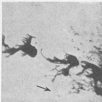
Abb. 1. Die Luft reisst vom Brennstoff Fetzen ab, die infolge der Oberflächenspannung zu Tröpfchen zusammenschrumpfen. Mikrophoto (siebenfach vergrössert) des NACA.
