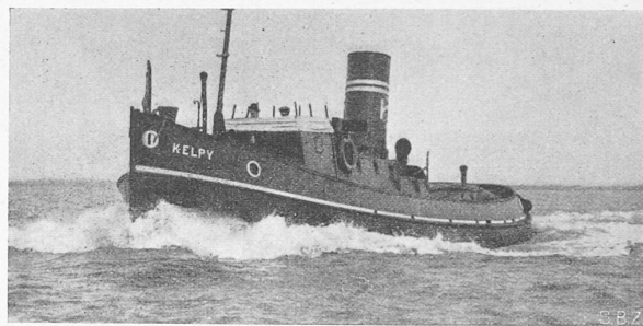
Abb. 4. Englischer Dieselschlepper mit 300 PS-Allen-Motor und „SLM-Winterthur“-Wendegetriebe.
