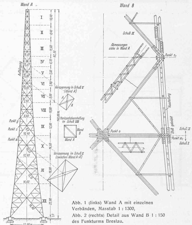
Abb. 1 (links) Wand A mit einzelnen Verbänden, Masstab 1 : 1300, Abb. 2 (rechts) Detail aus Wand B 1 : 150 des Funkturms Breslau.
