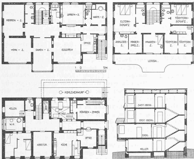
Abb. 19 und 20. Wohnhaus mit Arztpraxis von Dr. J. L. Burckhardt, Davos. Ansicht der Südfront; Schnitt und Grundrisse vom Kellergeschoss, Erdgeschoss und ersten Obergeschoss. — Masstab 1 : 400.
