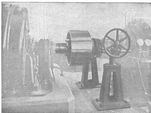
Benne-Kupplung zur Uebertragung von 3000 PS bei 1000 Um-
