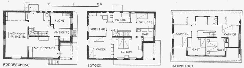
Abb. 2. Grundrisse. — Masstab 1 : 400.
