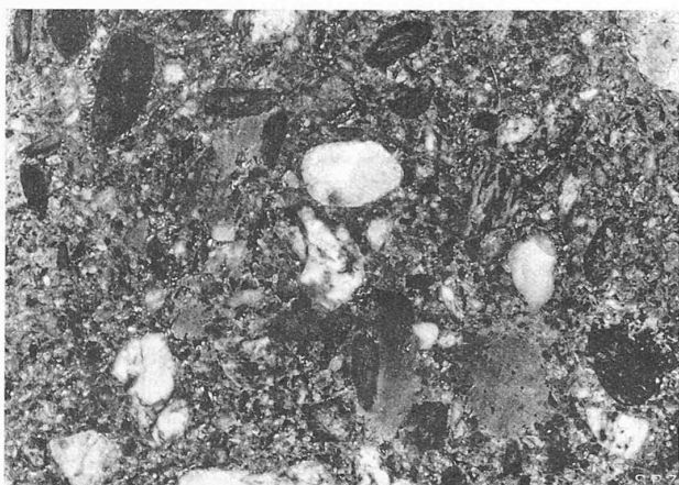
Abb. 13. Gewölbebeton-Schliff, in natürlicher Grösse.
