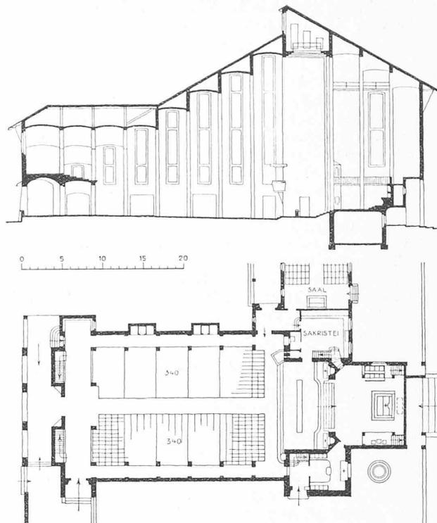
Abb. 5. Grundriss und Längsschnitt zu Abb. 4. — Masstab 1 : 600.
