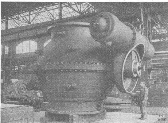
Kugelschieber mit einer Lichtweite von 2000 mm für
