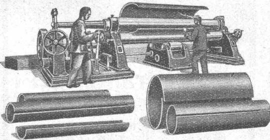
Dreiwalzen Blech-Rund- oder Biegemaschine zum zylindrischen und konischen Einrollen von Kesselschüssen, Rohren, Behältern u.s.w. für Bleche bis zu 25mm Dicke bei 4000mm größter Breite, mit maschineller Höhenverstellung und Kippvorrichtung der Oberwalze.
