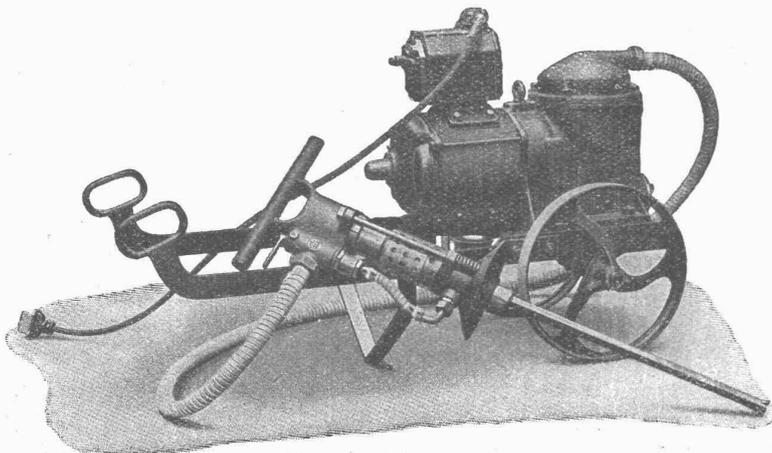
durch elektrisch-pneumatische Fein-Hammer-Anlagen mit Bohr- und Meissel-Pistolen
