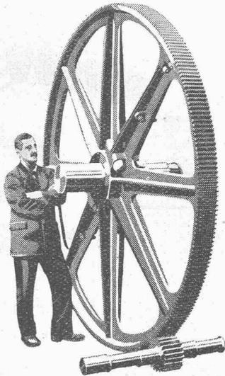
Ritzel mit gehärteten und geschliffenen Zähnen
