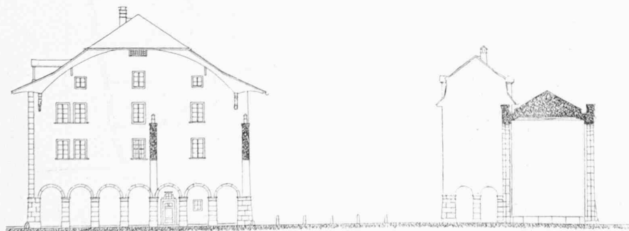
I. Preis (2200 Fr.), Entwurf Nr. 8 „Mehr Licht“. — Verfasser Architekt Emil Schäfer in Zürich. Schnitt durch die Strassenaxe: links Tor II, rechts Obertor. — Masstab 1 : 400.
