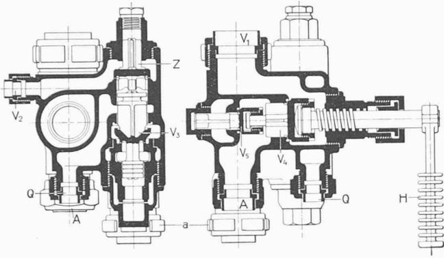
Abb. 2 und 3. Vertikalschnitt durch das Anlass- und Umschaltventil.
