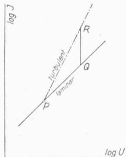
Uebergang von der laminaren zur turbulenten Bewegungsweise (Abb. 1) rückt gegen den Punkt  $P$  umso näher heran, je grösser die Störung ist. Dem Punkte  $P$ , dem etwa  $E_p = 1160$  bei gezogenen Messing-Rohren nach den Versuchen von Schiller entspricht, kommt nun besondere Bedeutung zu; von  $P$  ab kann nämlich überhaupt erst die laminare Bewegung in die turbulente übergehen. In  $P$
