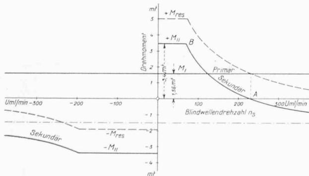
Abb. 12. Drehmomente an der Blindwelle des Zahnädergetriebe.
