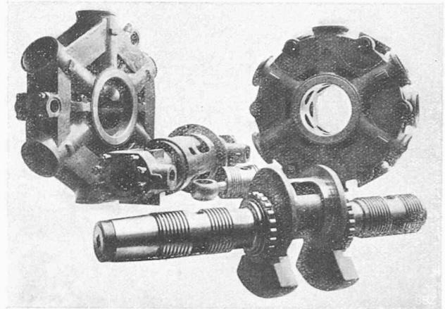
Abb. 8. Einzelteile des Primär- und des Sekundärgetriebes.
