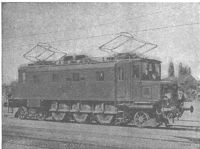
Einphasen-Schnellzuglokomotive mit Einzelachs Antrieb Bauart Brown Boveri, Type 2 C1.
