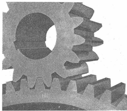
Tram-Getriebe mit gehärtetem und geschliffenem Maag-Ritzel nach einem Parcours von ca. 65000 km
