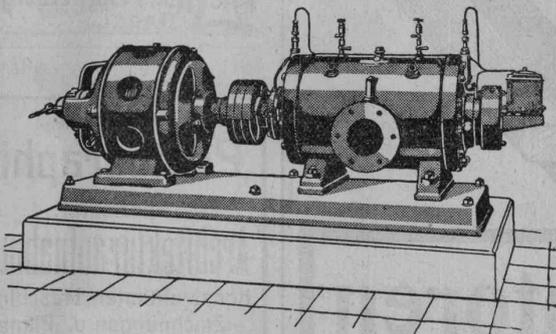
**Direkte Kupplung** mit Elektromotoren oder Riemenantrieb
