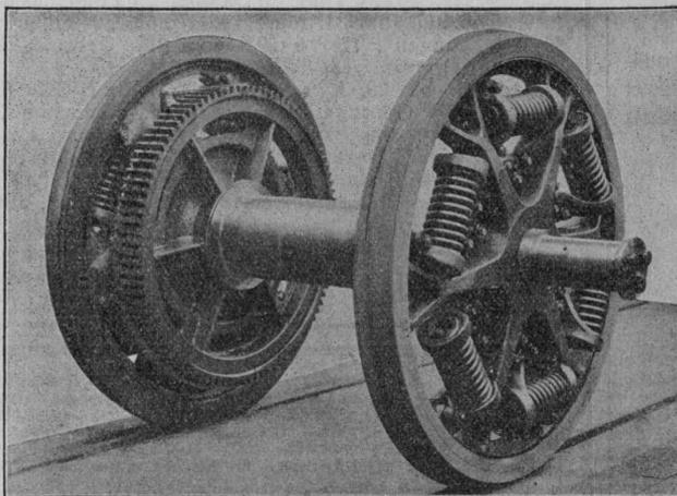
ESSIEU MONTÉ, DE LOCOMOTIVE ÉLECTRIQUE, AVEC ARBRE CREUX ET
