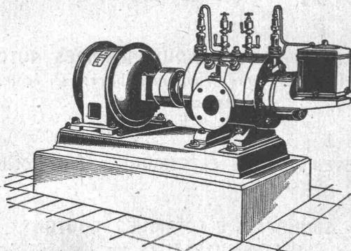
Direkte Kupplung mit Elektromotoren oder Riemenbetrieb.
