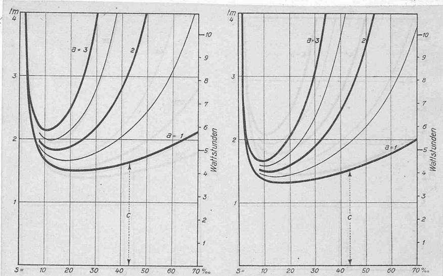
Abb. 8 und 9. Einfluss einer Aenderung des Wertes  $a = L : L_a$  auf den Wert  $c$ , gültig für  $f = 150 \text{ kg/t}$ ,  $w = 5 \text{ kg/t}$ ,  $a = 1$  bis 3.
