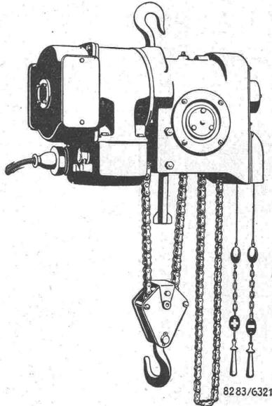
Die Steuerung erfolgt ausschliesslich durch Bürstenverschiebung
