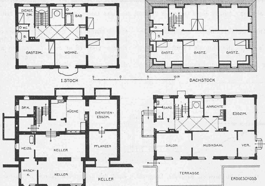
Abb. 4 bis 7. Grundrisse des umgebauten „Schlössli“ in Zollikon. — 1 : 400.
